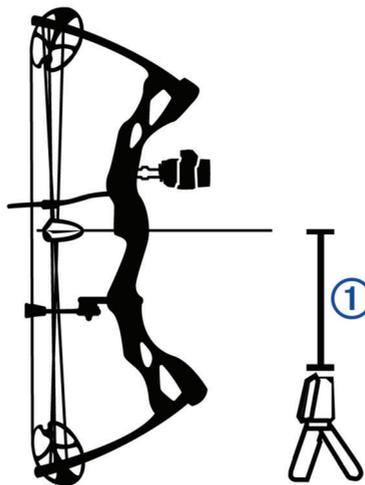
Das Gerät erkennt Schüsse und zeigt Messwerte automatisch beim Schießen an. Bei der gemessenen Geschwindigkeit handelt es sich um die Geschwindigkeit des Pfeils, während er über den Chronographen fliegt.
