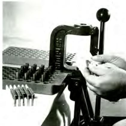
Hülsen reinigen und auf Beschädigung
